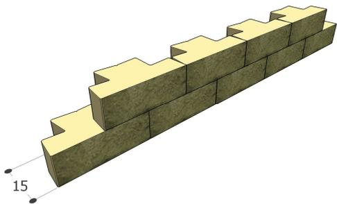
TRANCIANDO L'ELEMENTO IN CANTIERE, CON UNO SCALPELLO A PUNTA LARGA, SI POSSONO FACILMENTE OTTENERE GLI "ANGOLARI" E L'ELEMENTO DI "TESTATA" PER MURI CURVILINEI.
