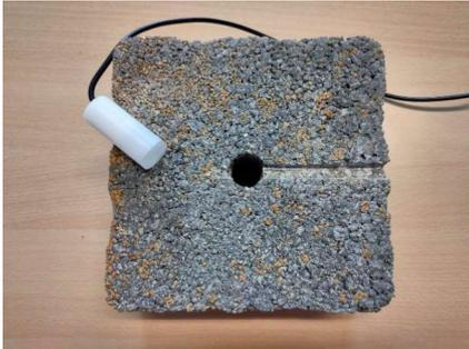
**Step 2:** Fissare vite autofilettante nel cilindro **LED**, per garantire maggior pressione e stabilità al cilindro all'interno del foro. Sia lastre che masselli autobloccanti con inserto **LED**, vanno posati in maniera tradizionale sullo strato di allettamento in ghiaio.
